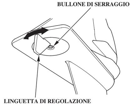
Se si tira da un lato il maniglione di governo/timone quando si procede alla massima velocità, regolare la linguetta in modo che l'imbarcazione proceda diritta.
