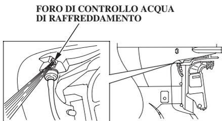
Tramite questo foro viene controllata la regolare circolazione dell'acqua di raffreddamento all'interno del motore.
