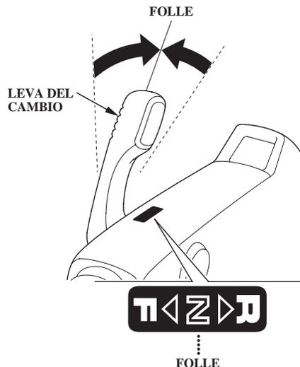
2. Portare la leva del cambio sulla posizione NEUTRAL (folle). Il motore non parte se la leva del cambio non si trova in tale posizione.
