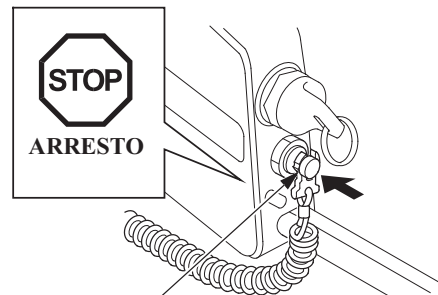
INTERRUTTORE ARRESTO DI EMERGENZA
